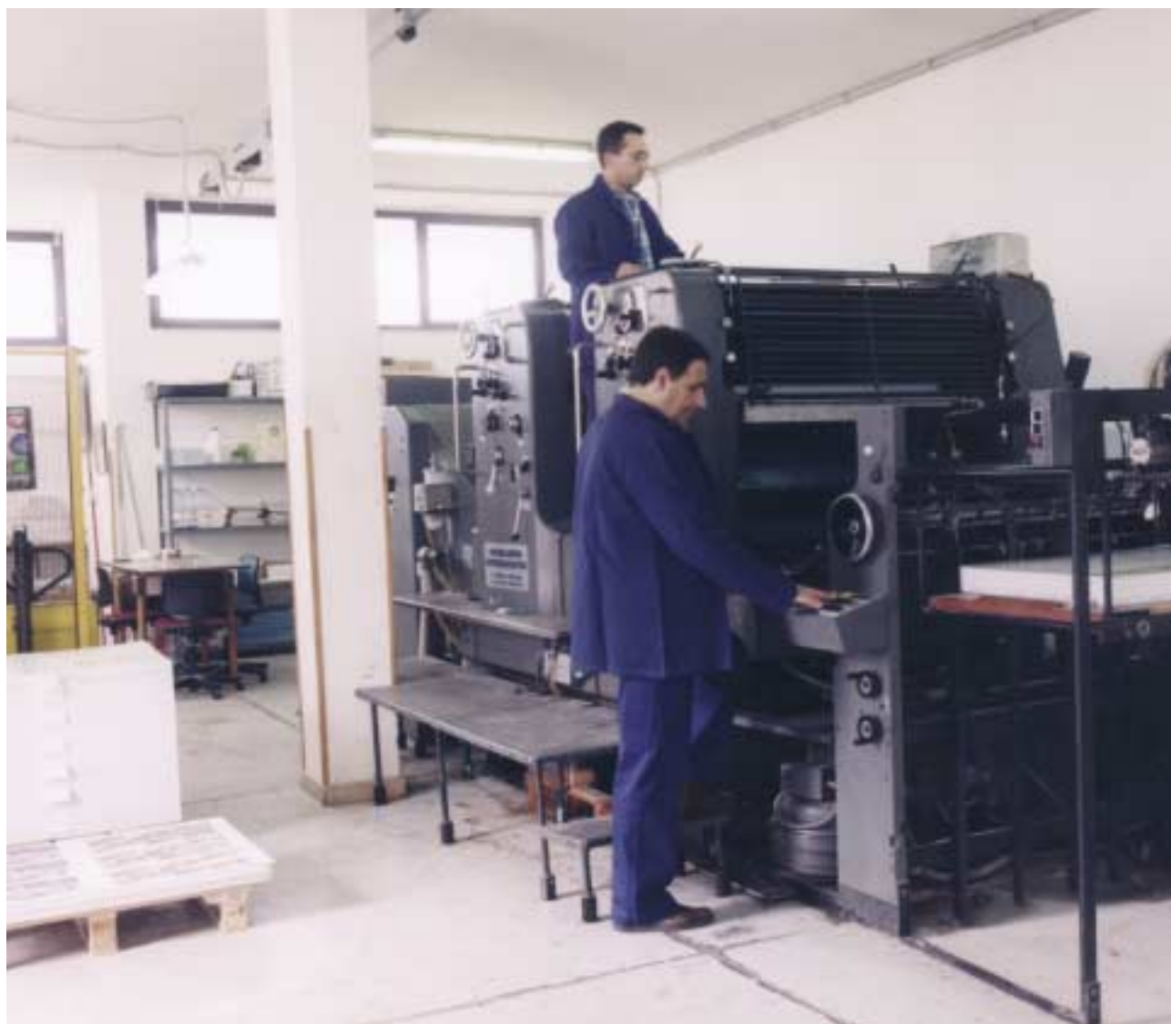
Stampa offset su macchine Heidelberg Speedmaster.
